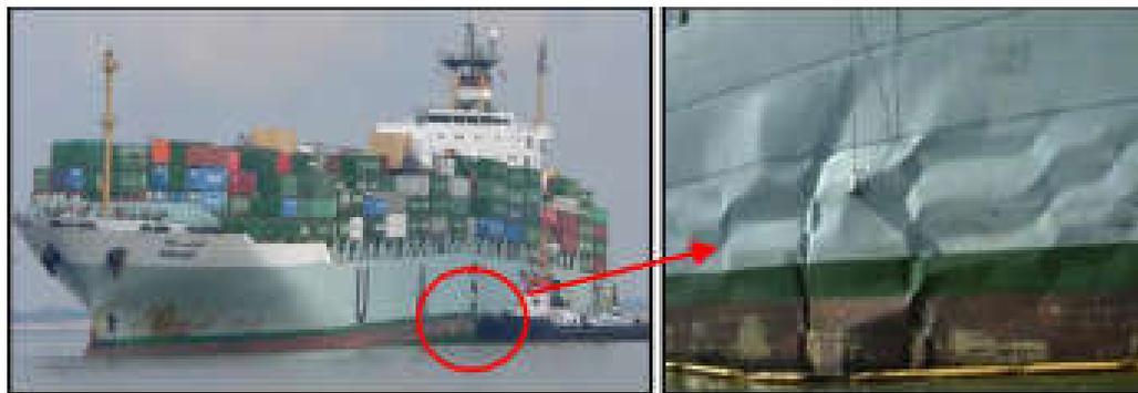
Figura 1.4 - Colapso global de um navio na condição de alquebramento, [Chujutalli, 2010].
