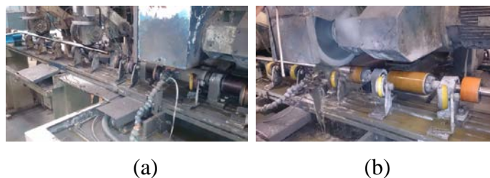
Figura 10: Preparação do pedaço de barra na retífica centerless . (a) Montagem; (b) polimento.
