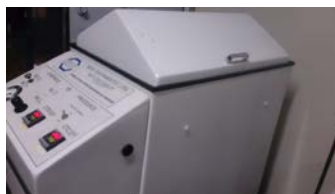
Figura 20: Câmara de Salt Spray BASS USP-00 utilizada para os ensaios.
