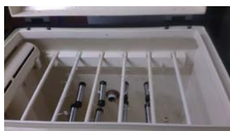
Figura 21: Disposição dos corpos de prova na câmara para iniciar o ensaio.
