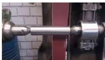
Figura 18: Acabamento final dos corpos de prova no torno polidor.
