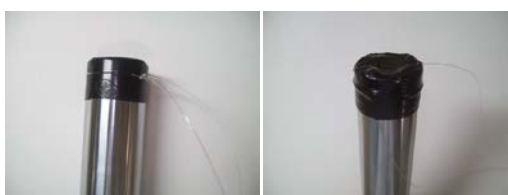
Figura 19: Isolamento dos corpos de prova com fita isolante e colocação do fio de nylon.
