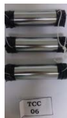
Figura 28: Registro fotográfico final dos corpos de prova TCC 06 da segunda parte do trabalho, após 168 horas de exposição ao ensaio de névoa salina.
