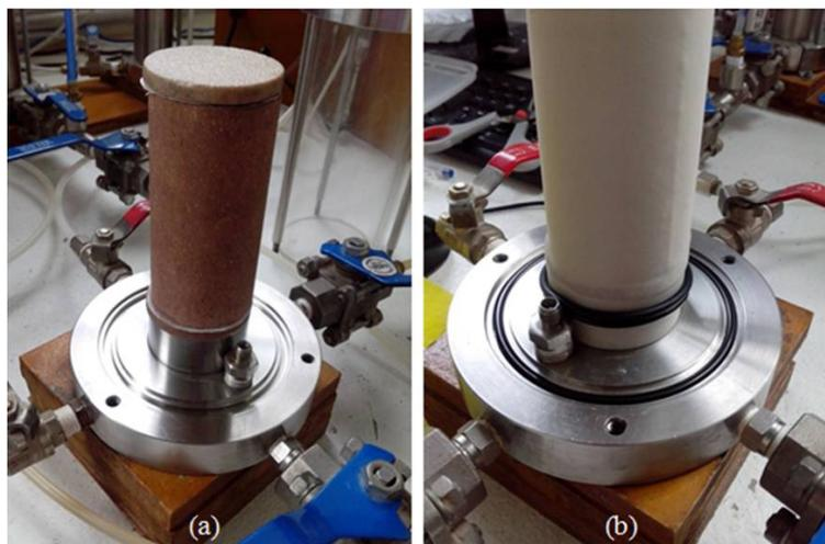
Figura 3.25: instalação da amostra: (a) detalhe do corpo de prova e pedras porosas; (b) detalhe dos *o-rings* de vedação.
