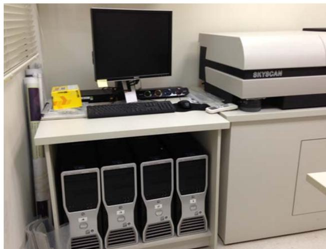
Figura 3.11: *cluster* de computadores utilizados para o processamento de imagens.
