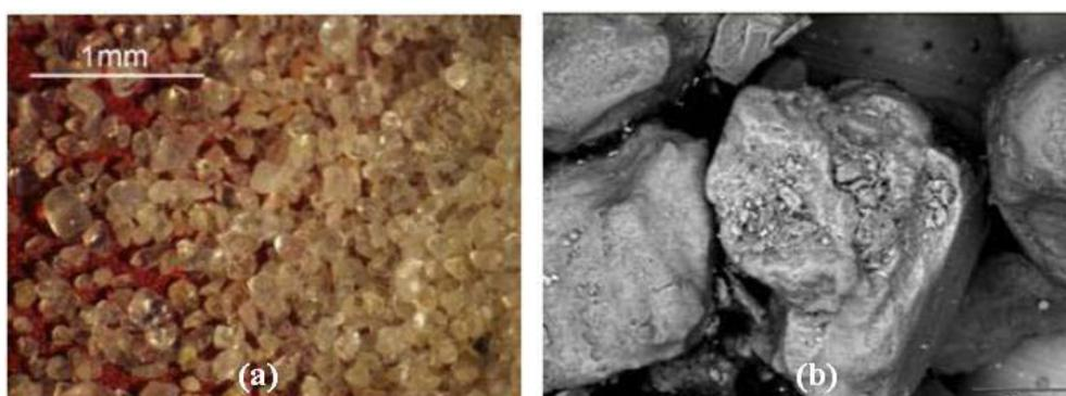
Figura 3.2: imagem da areia de Osório (a) ampliada em 40 vezes e (b) ampliada em 500 vezes (DALLA ROSA, 2009, p. 99).
