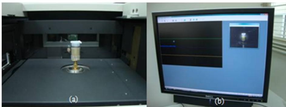
Figura 3.12: amostra no compartimento de análise do microtomógrafo: (a) posicionada no sistema de rotação; (b) visualizada a partir da tela do computador de operação.
