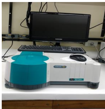
Figura 5 – Espectrofotômetro da marca Varian utilizado no método colorimétrico.
