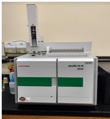
Figura 4 – Equipamento utilizado para determinação do COT.
