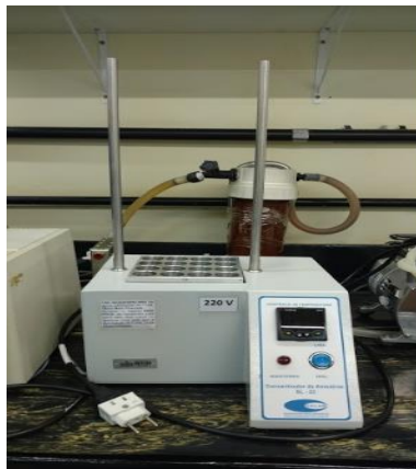
Figura 6 – Bloco digestor utilizado na determinação da demanda química de oxigênio.
