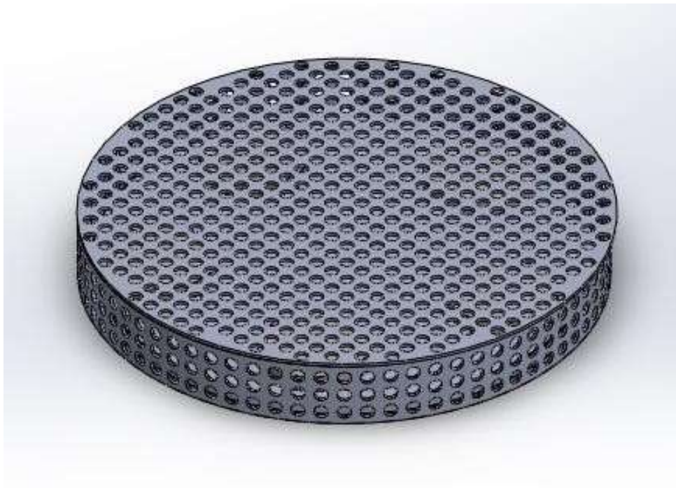
Figura 21. Vista isométrica do projeto da gaiola catódica
