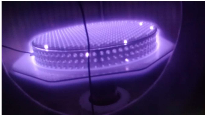
Figura 23. Processo de nitretação a plasma com gaiola catódica
