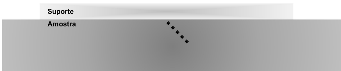
Figura 25. Esquema da medição do perfil de microdureza transversal
