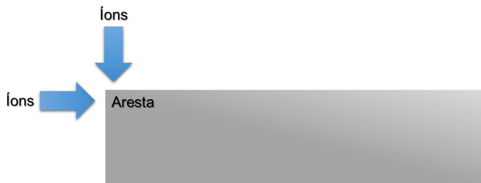
Figura 13. Figura esquemática do fenômeno do efeito de borda
