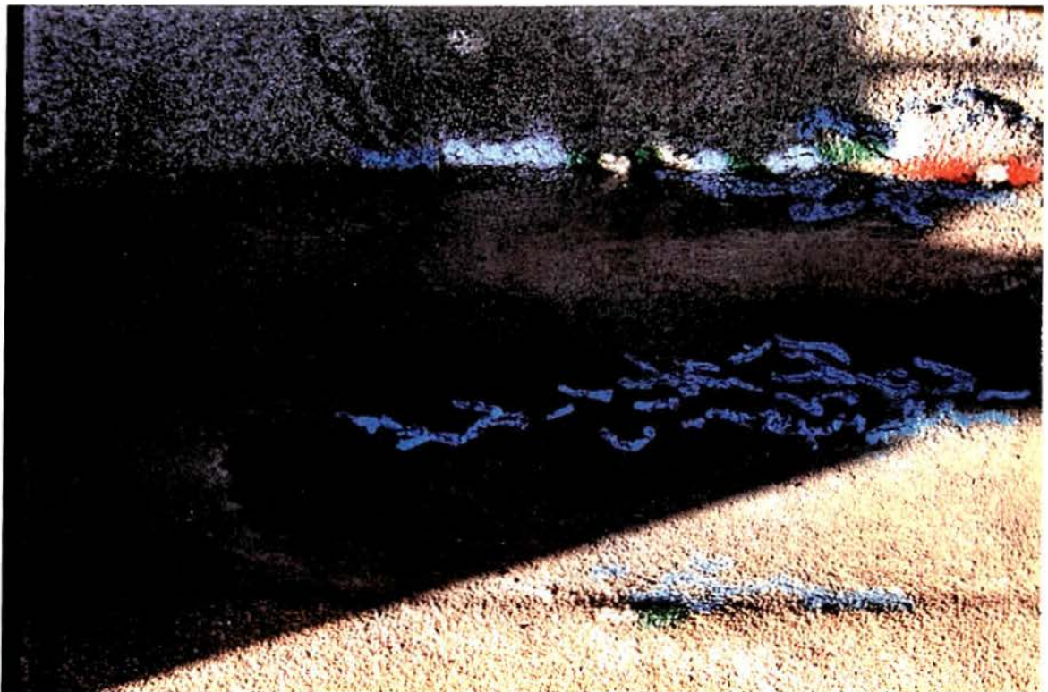
FIGURA 7.14 - Trincamento entre as seções S7 e S8 do setor 0110 após 16.500 ciclos
