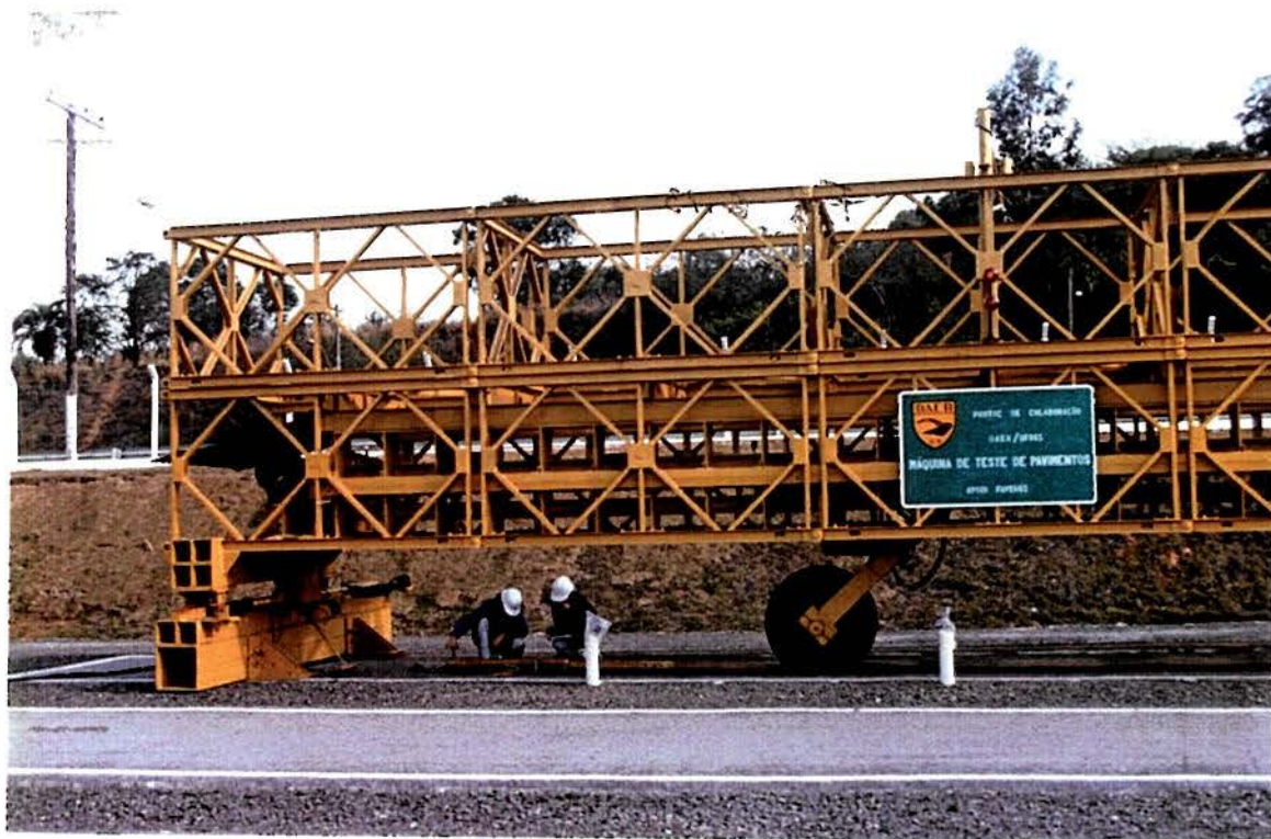
FIGURA 6.10 - Levantamento defletométrico com viga Benkelman
