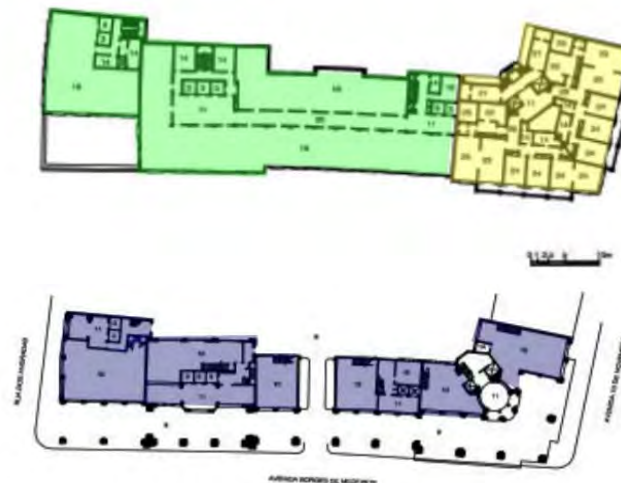
Figura 78: Plantas baixas do Edifício Sulacap. Abaixo – o pavimento térreo com as lojas, em azul, e a galeria. Acima – o pavimento tipo com funções distintas: salas comerciais, em verde, e apartamentos, em amarelo.
