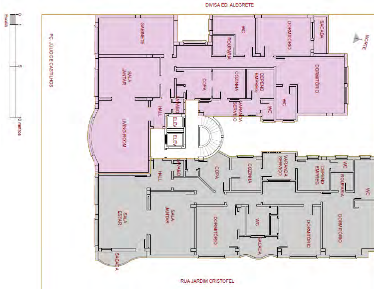
Figura 228: Planta baixa do pavimento-tipo do Edifício Plaza
