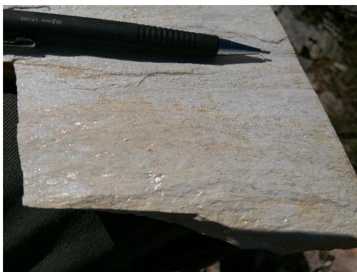
Figura 12 – Foto em detalhe da lineação de estiramento L_x com porfiroblastos de quartzo estirados e mica “fish”.
