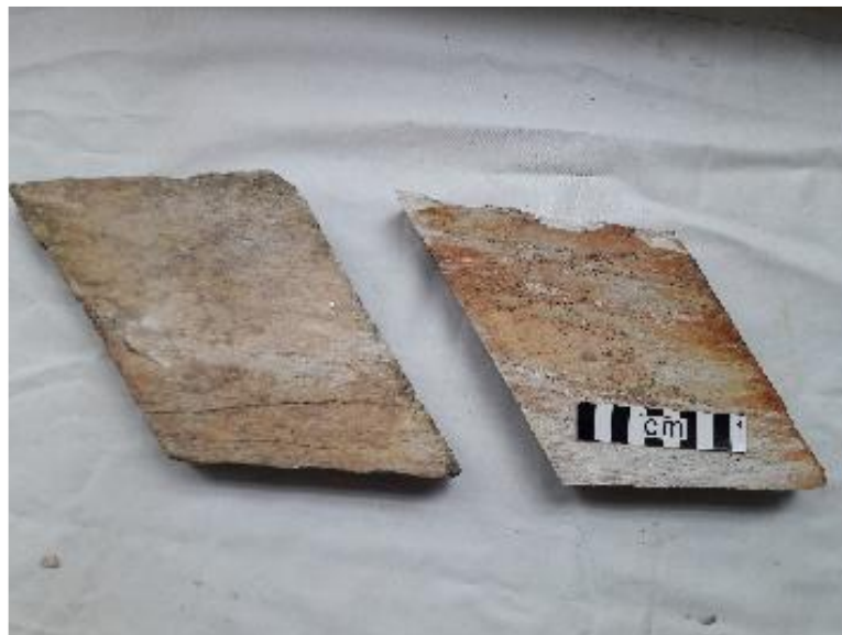
Figura 13 – Amostras com formato losangular irregular controlado pelas fraturas da rocha.
