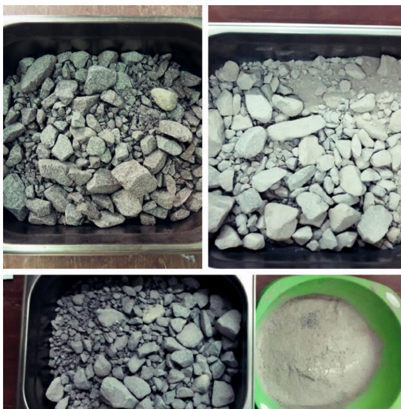
Figura 31: Agregados para ensaio abrasão Los Angeles. A) agregados antes do ensaio. B) agregados após ensaio. C) agregado após ensaio e peneirados.
