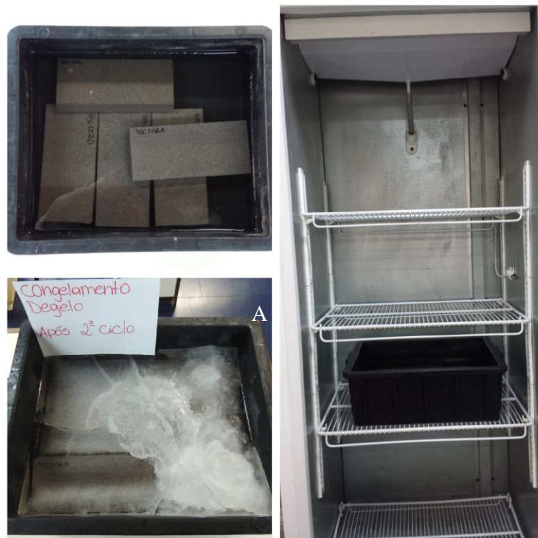
Figura 11: Ensaio de congelamento/degelo. A) amostras saturando B) amostras no freezer para congelamento a -15^{\circ}\text{C} C) amostras após 2º ciclo de congelamento.
