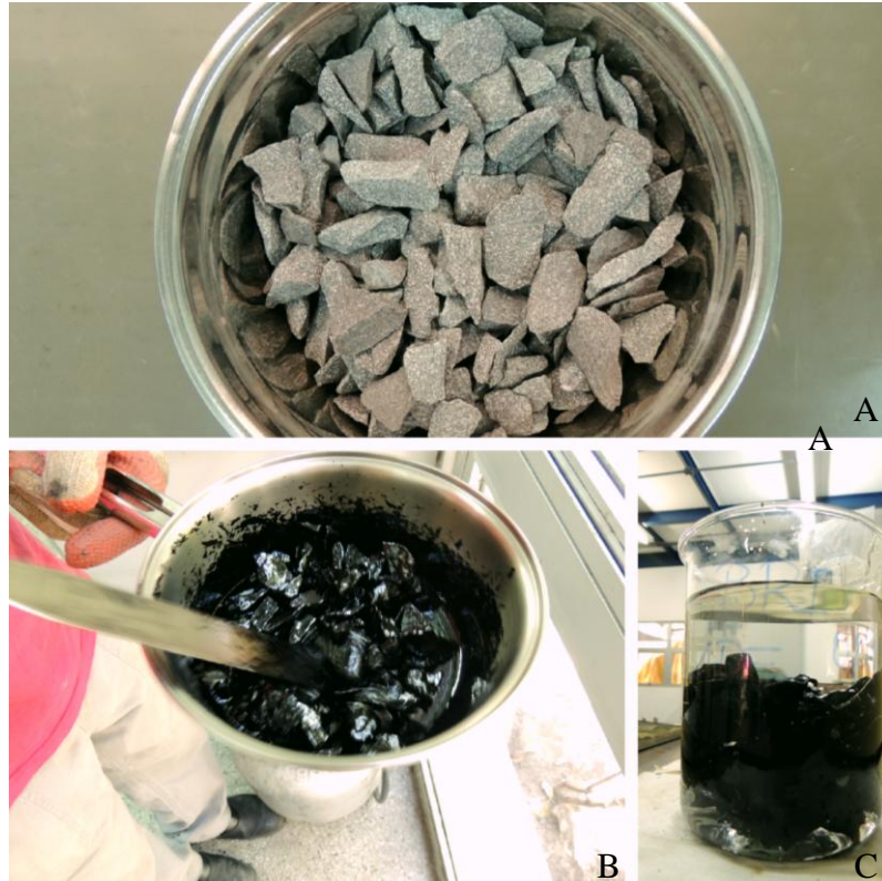
Figura 8: A) agregado para ensaio de adesividade. B) ensaio em andamento, agregado sendo recoberto com película betuminosa. C) agregado durante o ensaio coberto com película betuminosa e imerso em água destilada.
