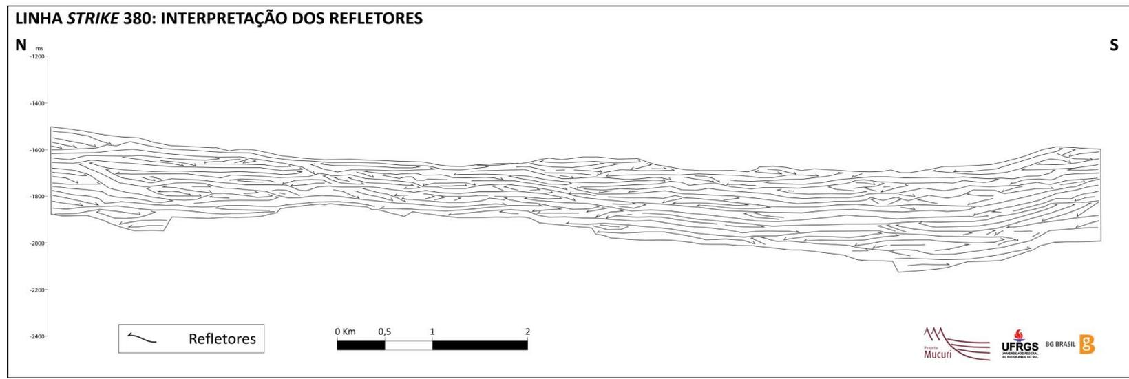
Figura 32: Interpretação dos refletores sísmicos e suas respectivas terminações na linha sísmica *strike* 380.
