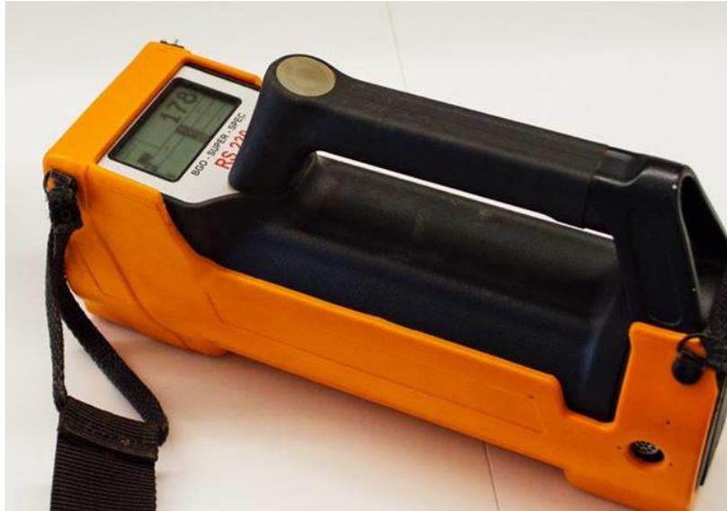
Figura 5 - Espectrômetro portátil de raios-gama portátil modelo Radiation Solucion RS 230.
