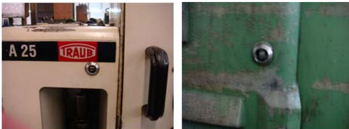
Figura 17 – Proteções mecânicas fixas itens 8 e 9. Fonte: Foto do autor, 2014.
