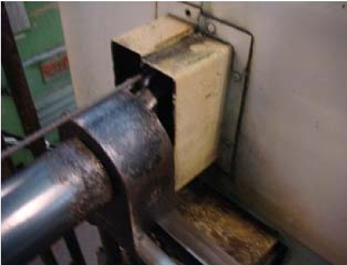
Figura 19 – Proteção mecânica fixa item 10. Fonte: Foto do autor, 2014.
