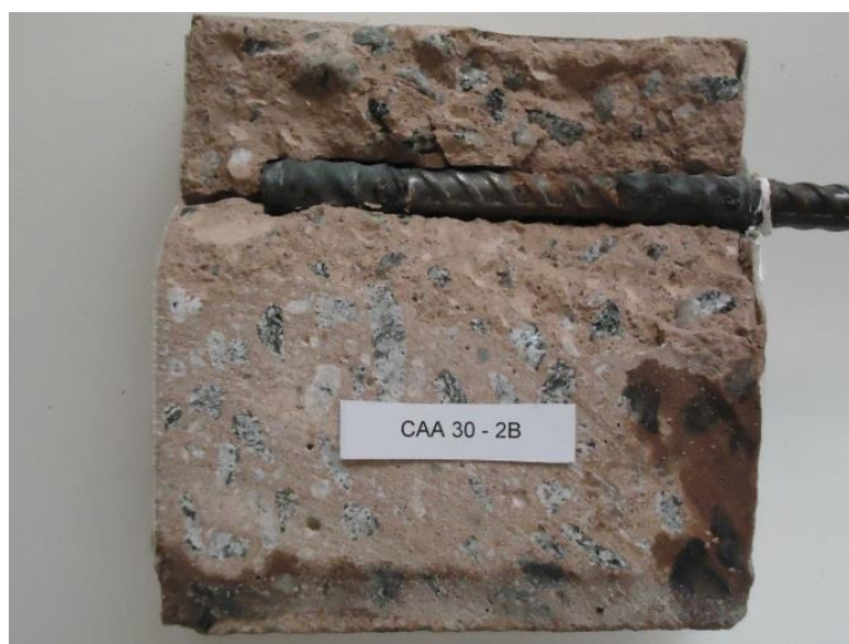
Figura 80 – Corpo de prova retirado do ensaio acelerado de cloretos, aberto para identificação dos pites de corrosão e retirada da barra (Arquivo pessoal)
