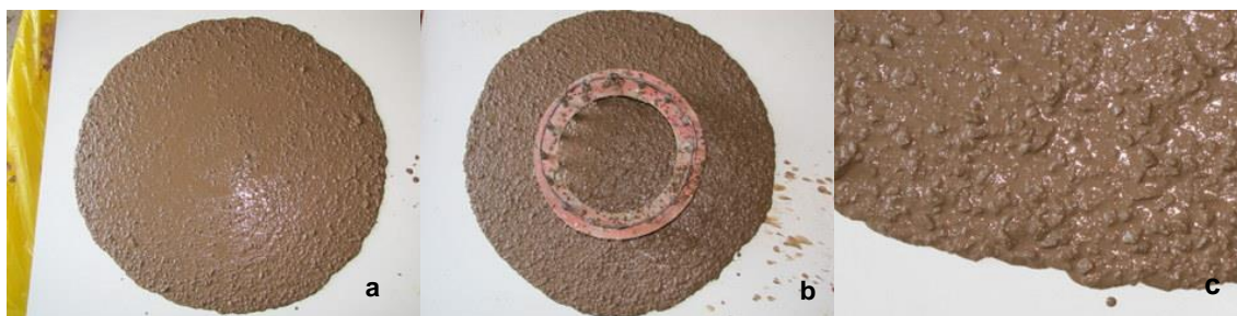
Figura 33 – Ensaio de espalhamento (a); ensaio com anel J (b); detalhes do CAA (c) (Acervo pessoal)
