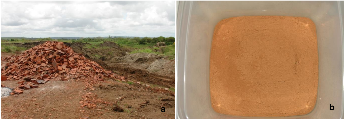
Figura 22 - Tijolos quebrados na indústria (a); tijolos triturados e moídos (b) (Acervo pessoal)
