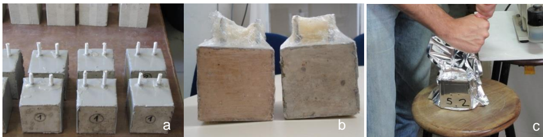
Figura 12 – CP com pintura epóxi (a); CP embalados com filme PVC (b); CP embalados a vácuo (c) (Acervo pessoal).
