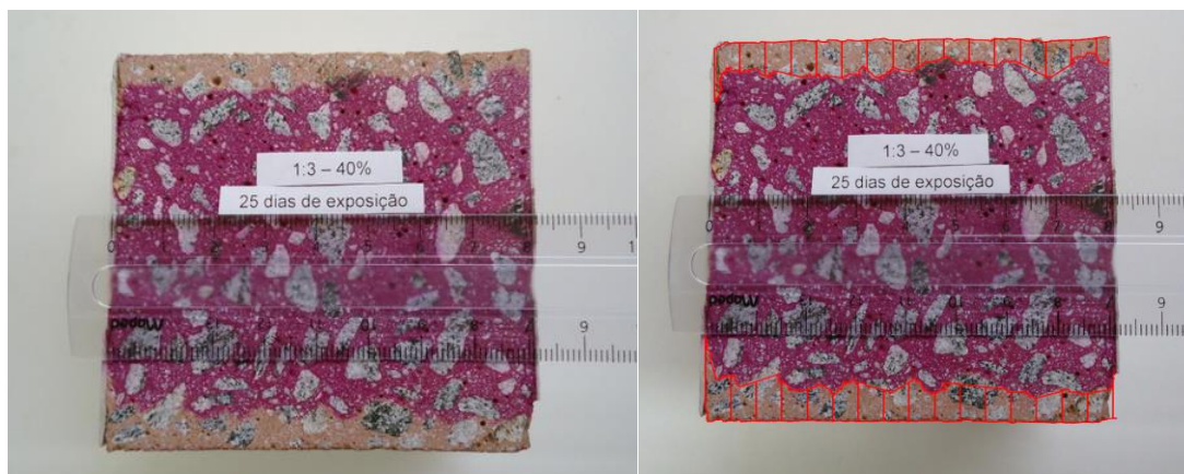
Figura 14 – Acompanhamento da frente de carbonatação por análise digital de imagem (Acervo pessoal)
