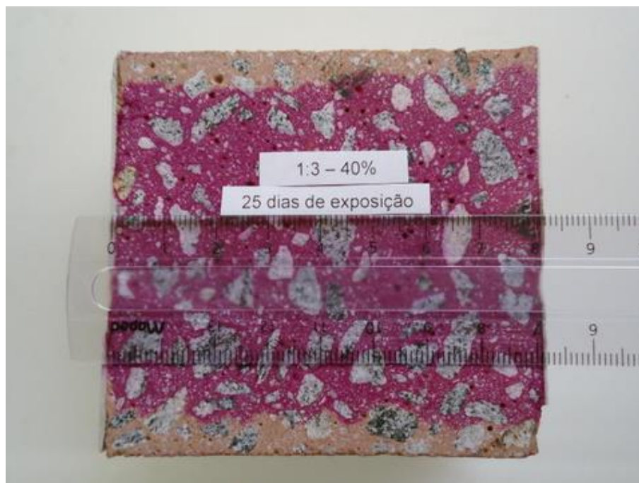
Figura 5 – Frente de carbonatação visualizada por reação com Fenolftaleína (Acervo pessoal)
