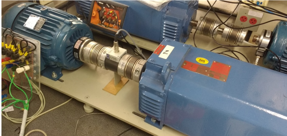
Figura 58 – Motor pentafásico acoplado ao gerador de corrente contínua utilizado nos testes
