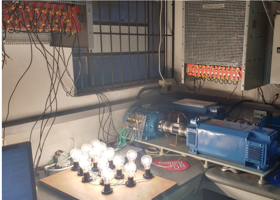
Figura 82 – Conjunto de cargas para os testes com potência nominal
