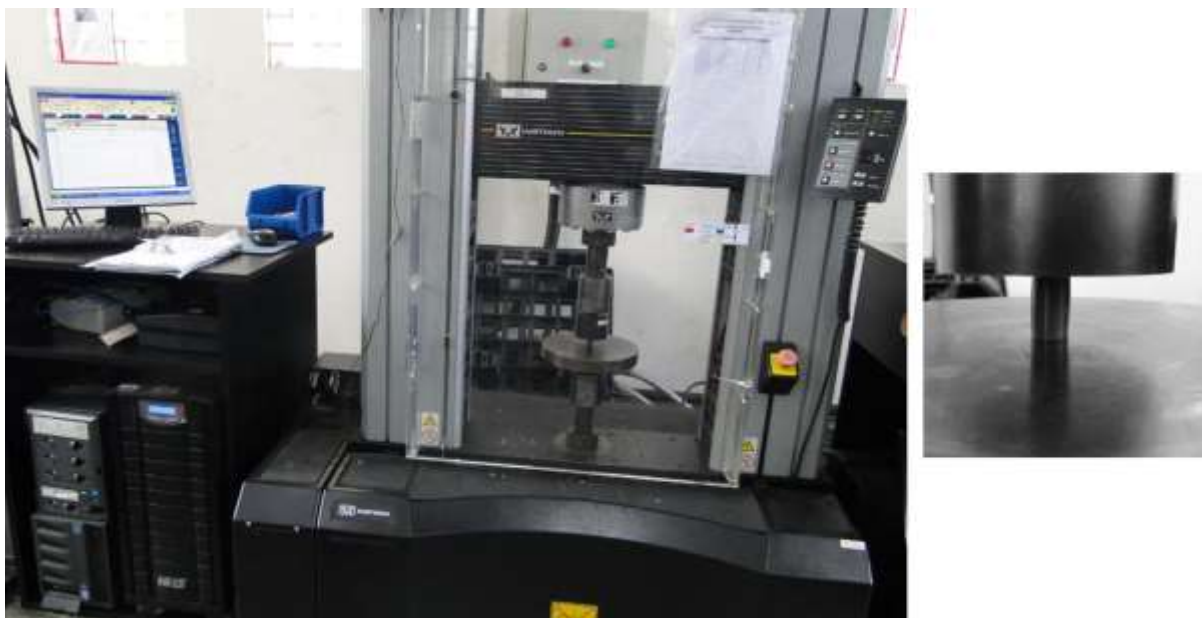
Figura 28: Máquina e dispositivos utilizados nos testes de compressão
