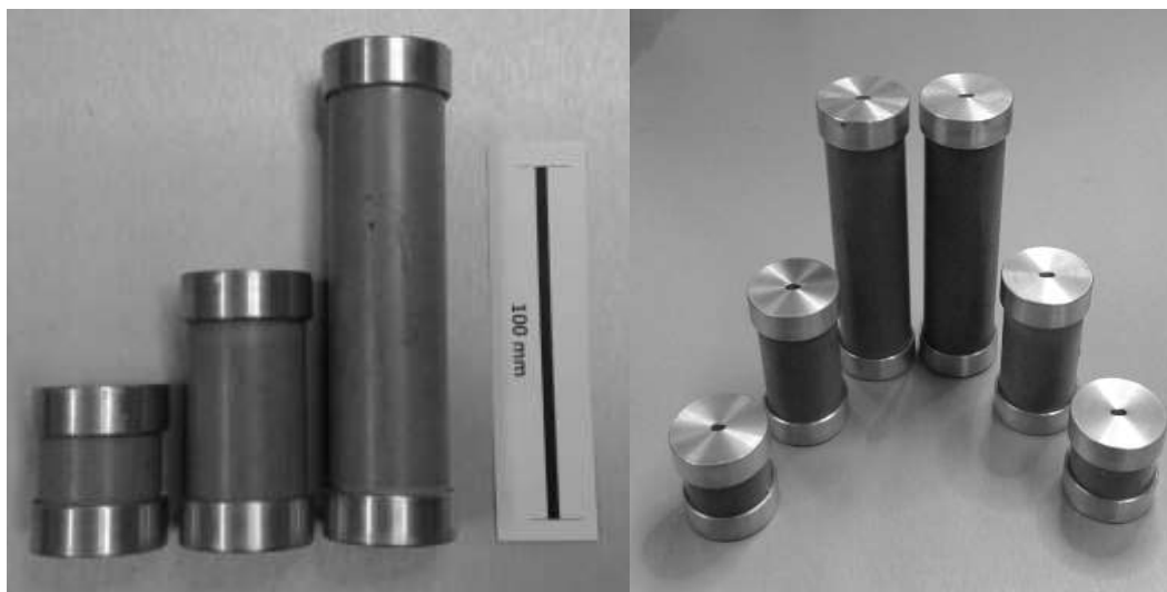
Figura 29: Conjunto de dispositivos para resinagem dos CP para pullout , 30/60/120 mm
