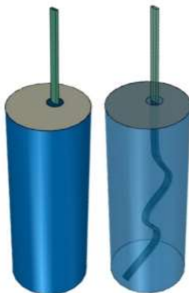
Figura 44: Configuração para pullout da ancoragem.
