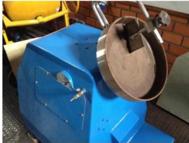
O disco utilizado foi o de 600 mm de diâmetro, sendo ajustado para um ângulo de  $52^\circ$  (c/ horizontal) e para uma velocidade de 30 rpm, segundo pré-testes e informação da literatura (MEYER, 1980). Além disso a alimentação do disco foi feita com uma taxa média de 0,66 kg/min. O teor de umidade das pelotas foi de aproximadamente 15%.
