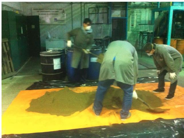
Os tipos usuais de quarteamento são pilha cônica, pilha longitudinal e quarteador tipo Jones. O quarteamento utilizado foi o de pilha cônica. Onde, antes de serem selecionadas as amostras, foi-se realizado um tombamento, para aí sim serem selecionadas as amostras.
