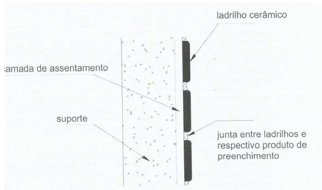
Figura 35 - Revestimento cerâmicos e constituintes<sup>20</sup>.
