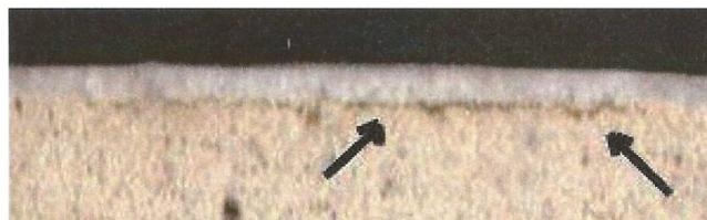
Figura 45 - Secção de um azulejo descascado, mostrando a separação local entre vitrado (branco) e biscoito<sup>31</sup>.
