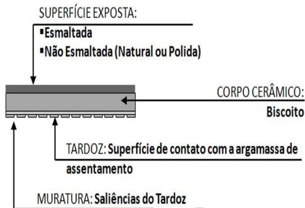
Figura 68 - Partes componentes de um azulejo.
