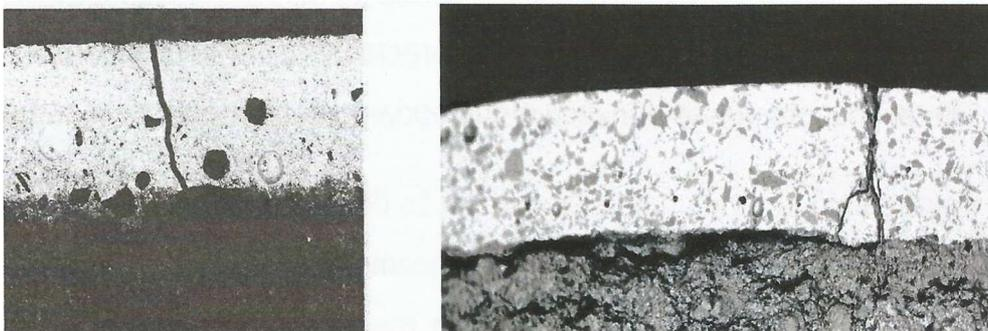
Figura 38 - Análise microscópica de propagação de fissuras (a) tipo I e (b) tipo II<sup>3</sup>.
