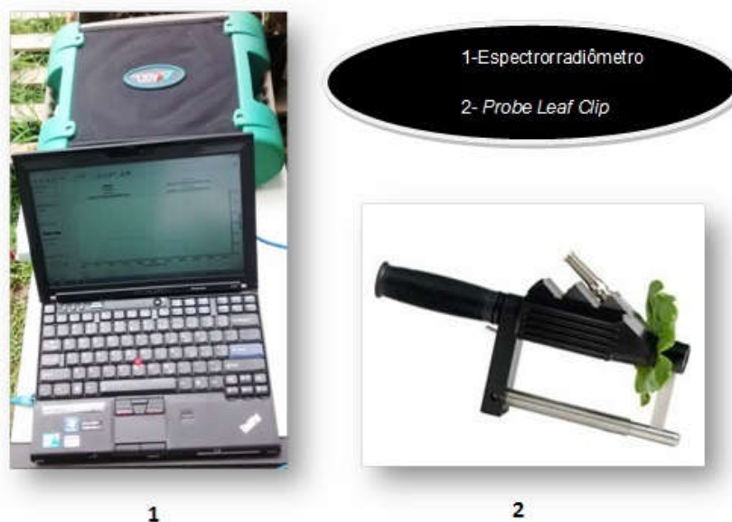
Figura 6. Espectrorradiômetro Field Spec 3 ASD e o acessório Probe Leaf Clip utilizado neste trabalho.
