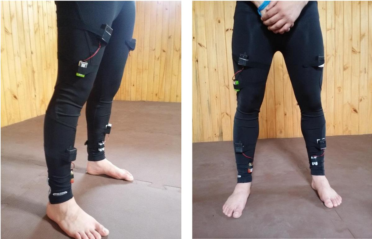
**Figura 5.10** Posicionamento dos sensores para ensaio da marcha.
