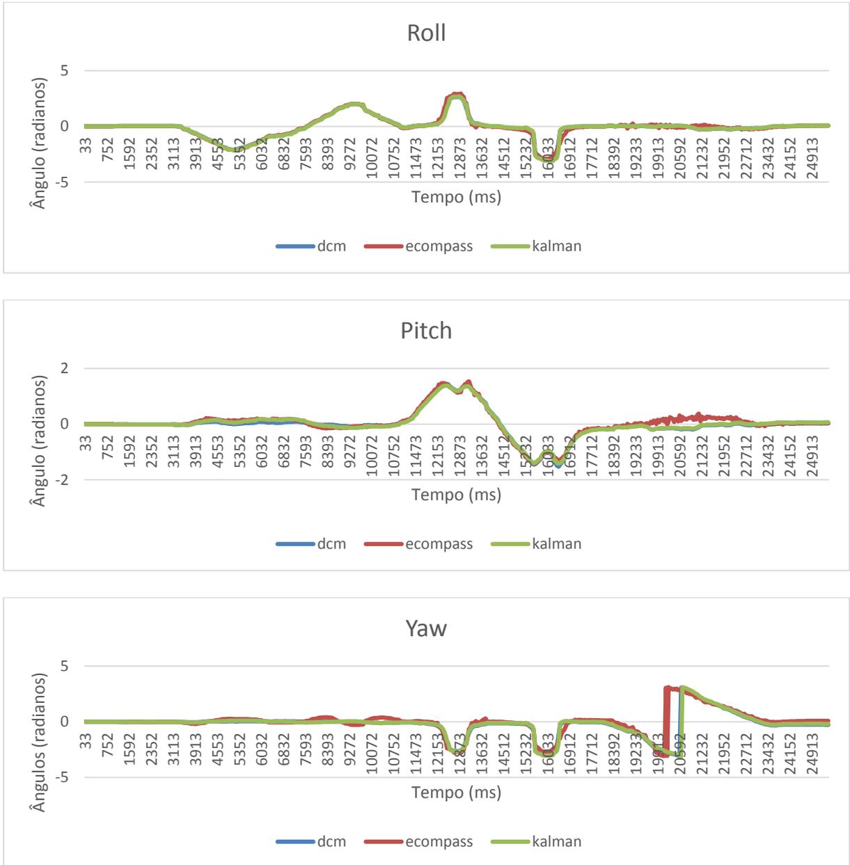
**Figura 5.2** Gráficos representando a métrica *attitude* em Euler XYZ com os três métodos: DCM, *eCOMPASS* e Kalman.
