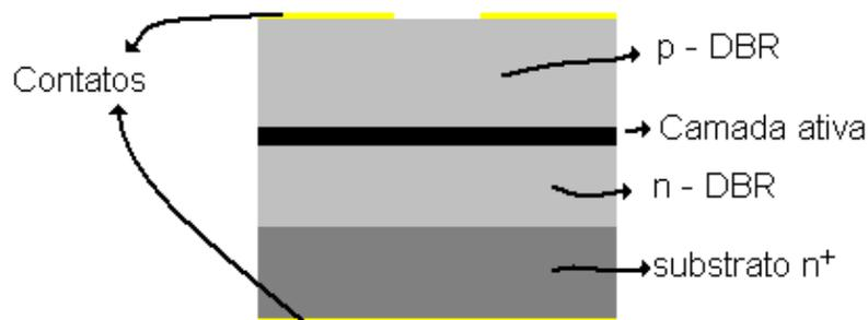
Figura 2-1 Estrutura básica de um dispositivo VCSEL.
