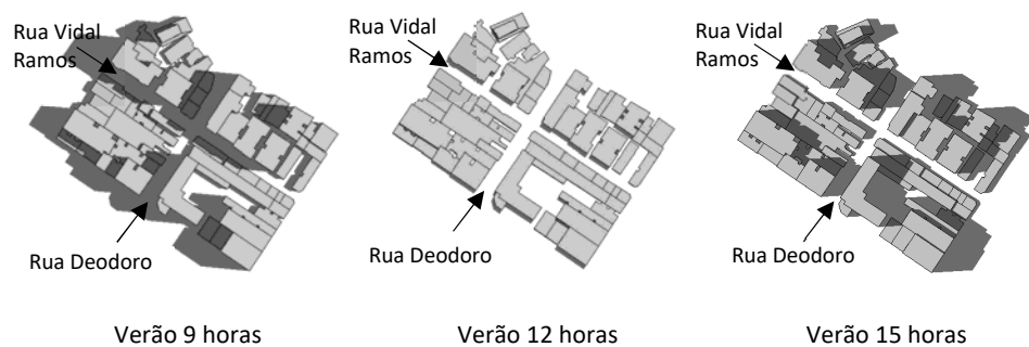
Figura 3-12 Sombreamento do conjunto construído 2 no verão. Fonte: Elaborado pela autora, simulação no software Ecotect.
