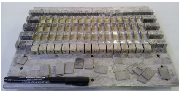
Figura 3.5: desmoldagem de corpos de prova para o ensaio de resistência à compressão
