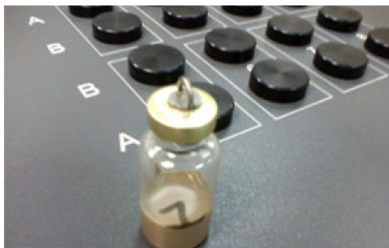
Figura 3.8: canais do calorímetro - recipiente com pasta de cimento a ser adicionada ao equipamento
