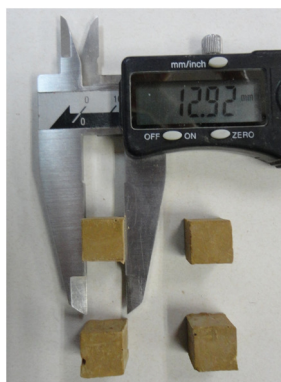
Figura 3.6: aferição com paquímetro digital das medidas dos corpos de prova para a determinação da resistência à compressão das pastas de cimento
