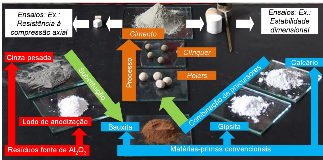
Figura 3.1: processo de produção do cimento em laboratório e os ensaios de caracterização
