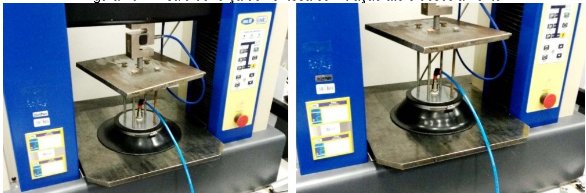
Figura 10 - Ensaio de força de ventosa com tração até o descolamento.
