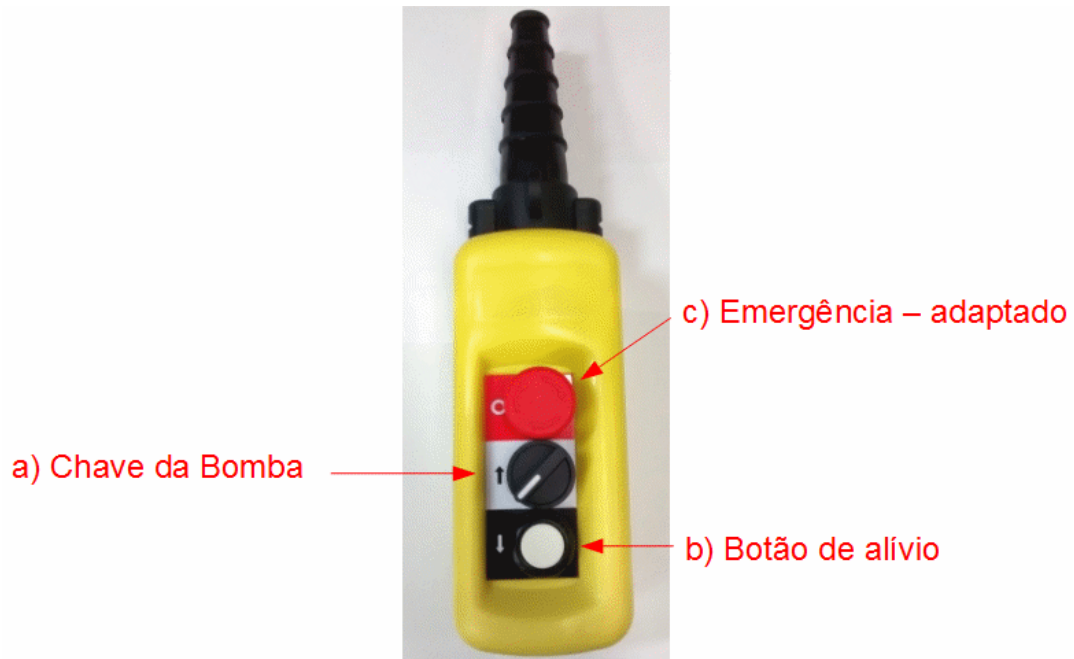
Figura 24 – Botoeira adaptada para controle do vácuo
