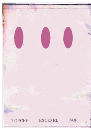
FIGURA 1.1 Perfil cromatográfico das amostras de ceftiofur (0,1 mg/ml) Excenel ® - Rf 0,76, Topcef ® Rf - 0,76 e SQR – Rf 0,76. Fase móvel: metanol, clorofórmio e acetona (9:8:1 V/V/V), após revelação com ninidrina.
