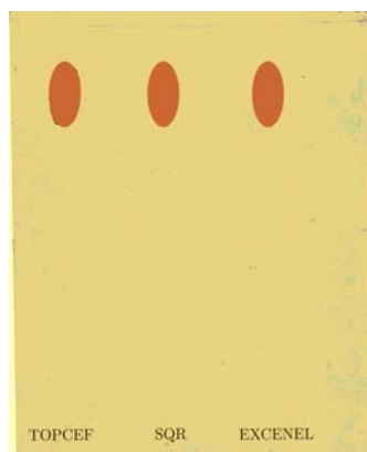
FIGURA 1.2 Perfil cromatográfico das amostras de ceftiofur (0,1 mg/ml) Excenel ® - Rf 0,81, Topcef ® - Rf 0,81 e SQR - Rf 0,81. Fase móvel: acetona e acetato de amônio a 15,4% (P/V) (3:7) pH 5,0 ajustado com ácido acético glacial, após revelação com vapores de iodo.
