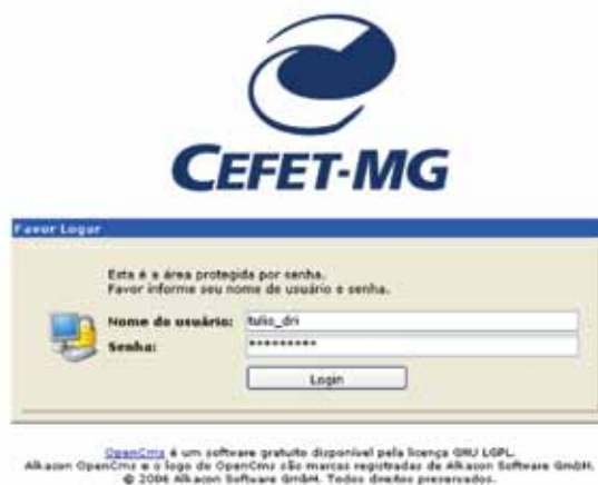
Figura 3: Autenticação do OpenCms é feito via LDAP, com o conceito de senha única, o usuário pode ser autorizado a acessar o WorkPlace do OpenCms do CEFET-MG.
