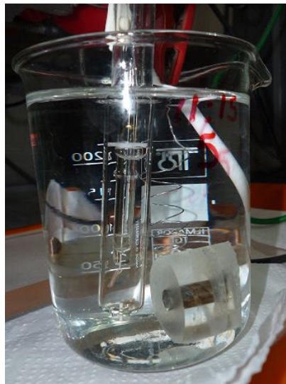
Figura 5. 5– Ensaio de EIE em andamento.
