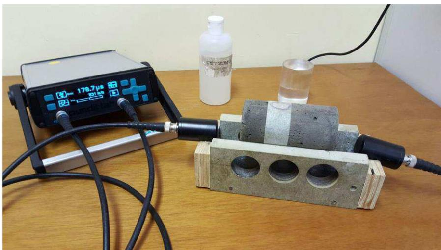
**Figura 42 - Aparelho para medição de onda ultrassônica da marca Proceq**
