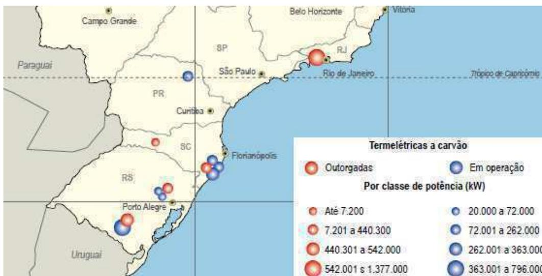
**Figura 1 - Mapa das termoelétricas a carvão no Sul do Brasil (Adaptado de ANEEL, 2008)**
