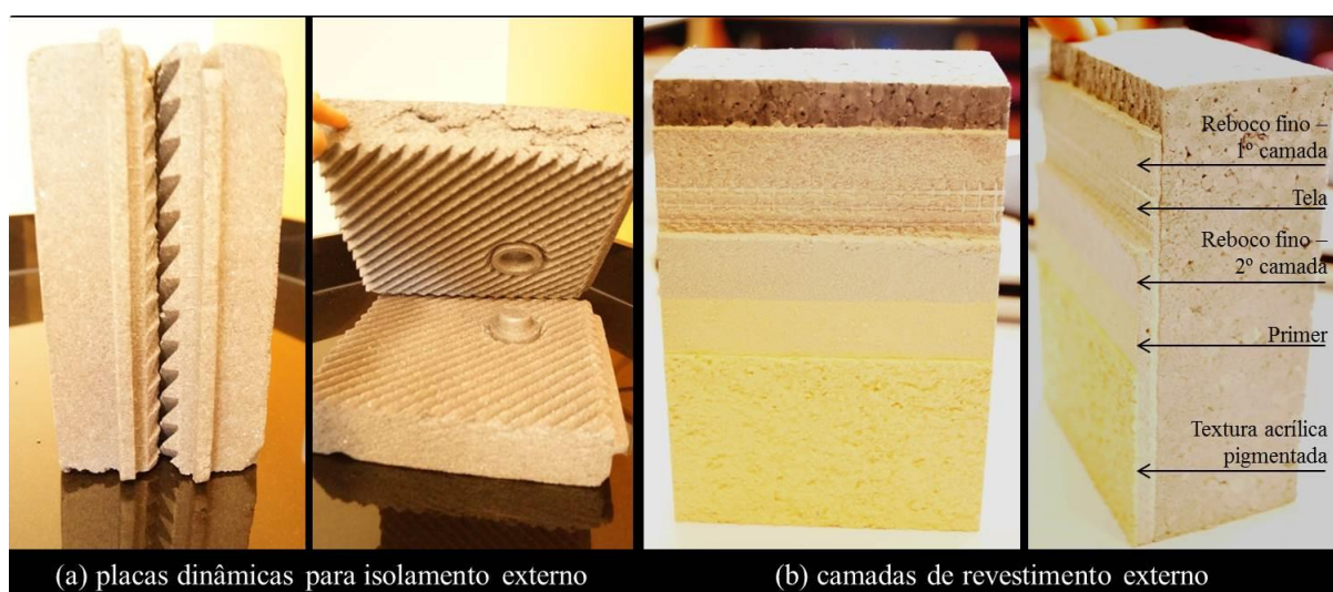
Figura 21: Materiais utilizados no isolamento térmico de paredes externas.
