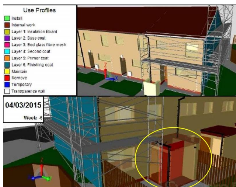
Figura 30: Uso de transparência e cores para representar a execução das atividades internas de retrofit .
