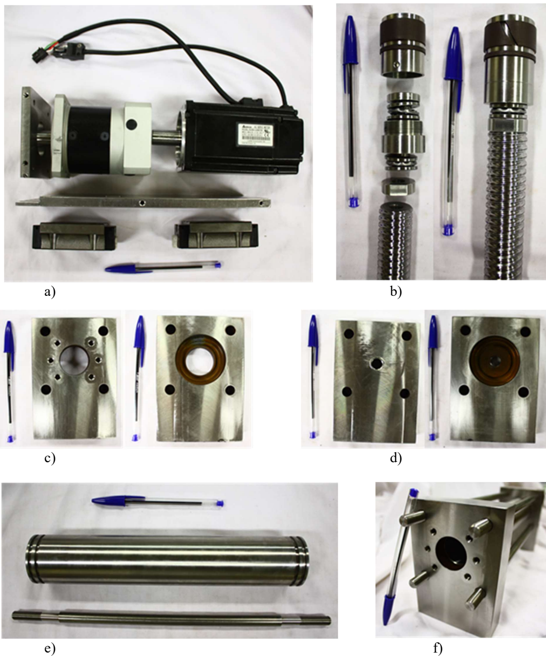
Figura 3.18 – Controlador de pressão: a) base para conjunto servomotor e redutor e patins; b) pistão e fuso de esferas; c) suporte para castanha e cilindro; d) suporte para ligação hidráulica e cilindro; e) cilindro hidráulico e haste; f) conjunto suportes, cilindros e hastes.
