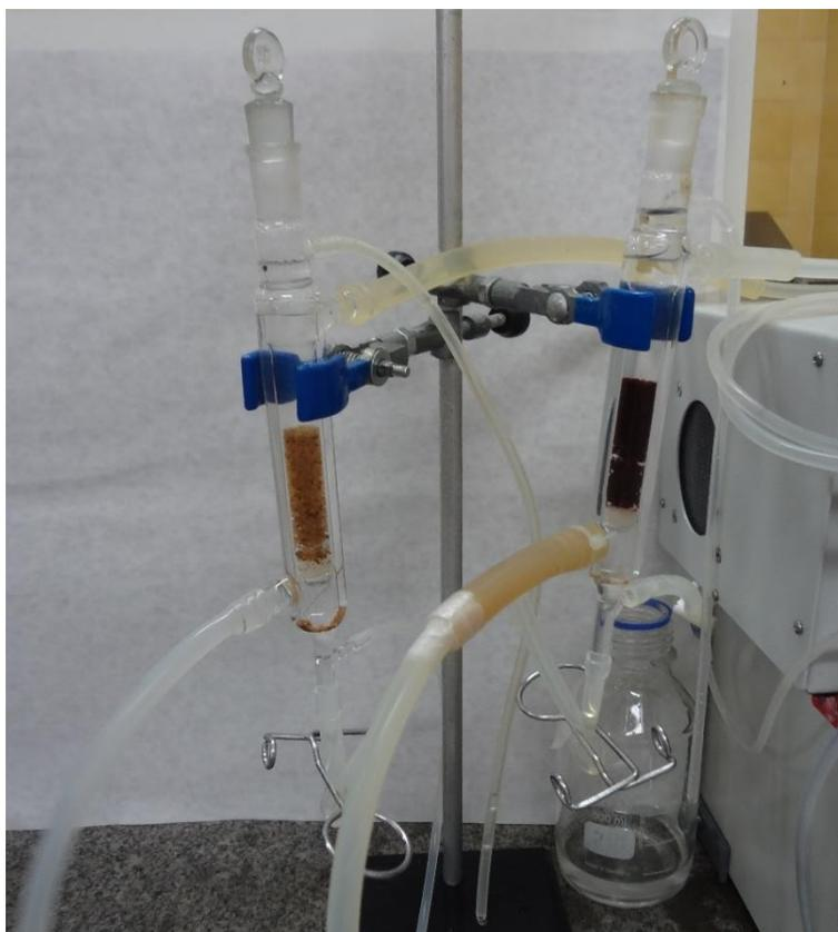
*Figura 8. Reatores utilizados no experimento: a esquerda reator contendo a enzima imobilizada no suporte SiQT10 e a direita a enzima imobilizada no suporte SiO<sub>2</sub>.*
