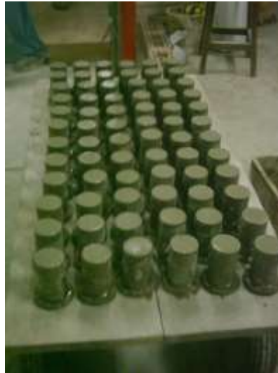
Figura 15: corpos-de-prova cilíndricos utilizados para os ensaios no estado endurecido
