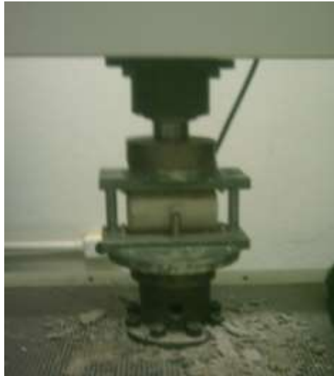
Figura 27: resistência à tração por compressão diametral de corpos-de-prova de argamassas
