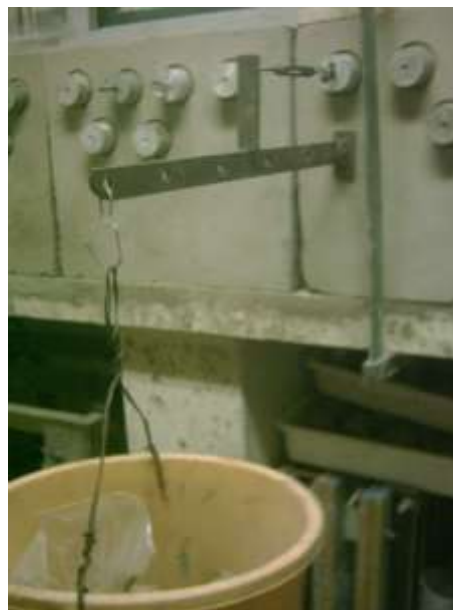
Figura 23: execução do ensaio de resistência de aderência à tração
