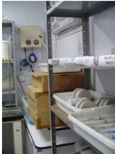
Figura 8: ambiente de cura das amostras com temperatura de 23 \pm 5^{\circ}\text{C} (sala climatizada)
