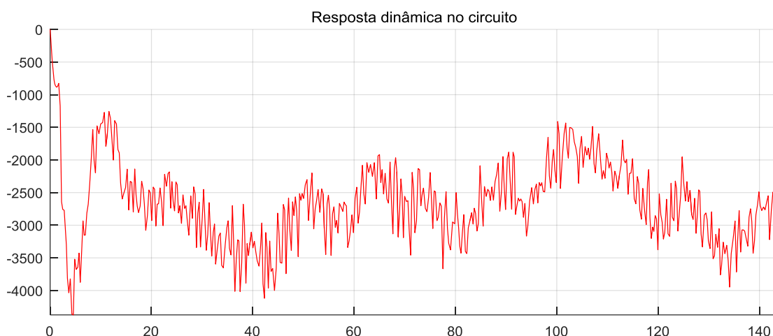
Figura 5.5 – Força resultante de compressão da mola no full model para pista de D'Apuzzo de grau C pela escala ISO 8608.
