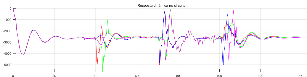
Figura 5.3 – Força resultante de compressão das molas no full model para pista com rampa senoidal. Rodas frontais, direito (F1) e esquerdo (F2) e traseiras, direita (F3) e esquerda (F4).
