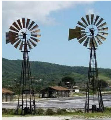
Figura 17 – Aerogerador de múltiplas pás ou cata-vento
