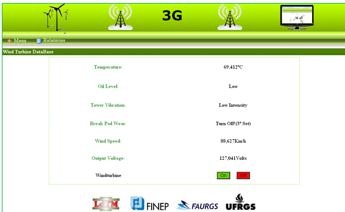
Figura 39 – Tela de acesso ao sistema de aquisição e monitoração via rede de celular 3G.
