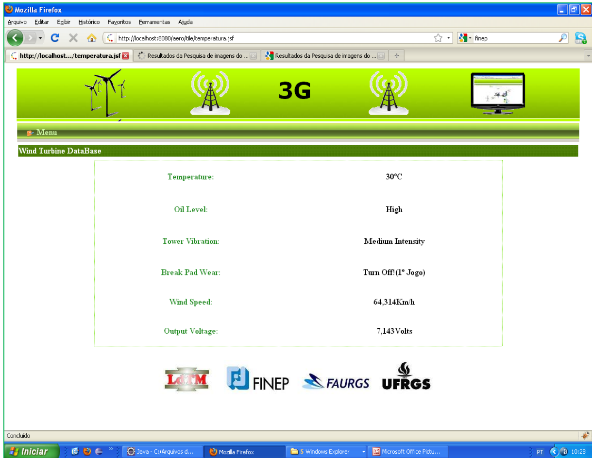
Figura 44 – Sistema de monitoramento remoto
