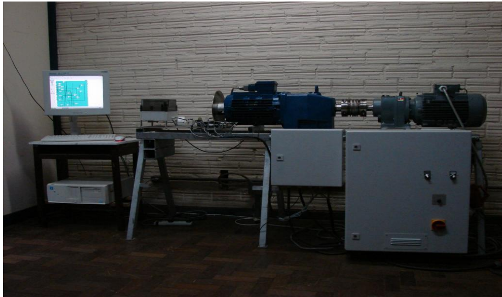
Figura 32 – Aerogerador montado em bancada.
