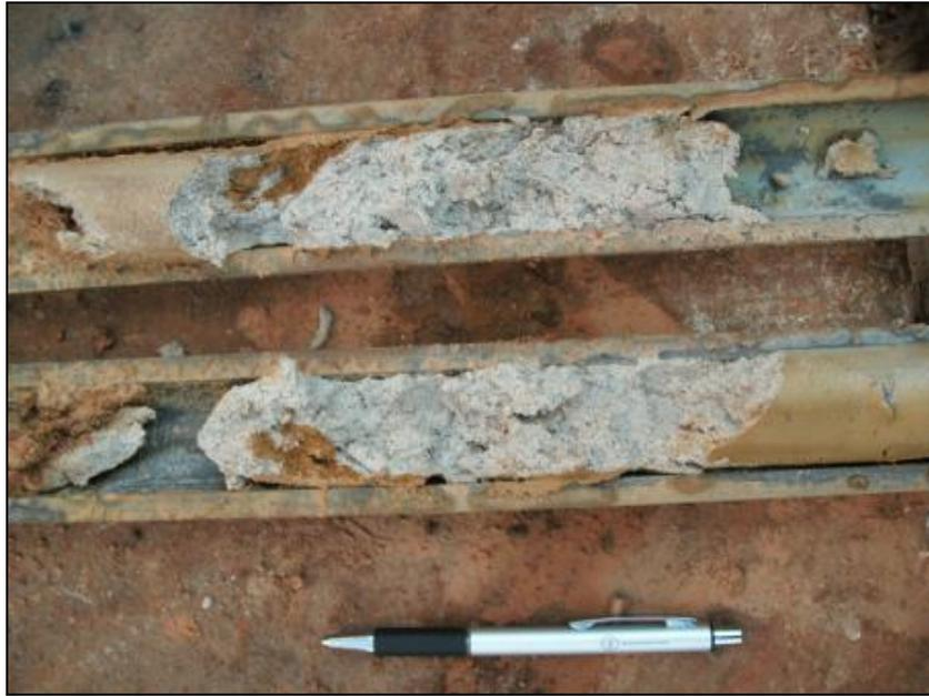
Figura 5. Material obtido na sondagem SPT com baixa resistência a penetração composto basicamente por fração arenosa.
