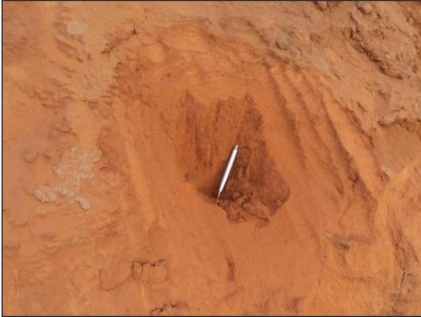
Figura 6. Foto de detalhe ilustrando a presença de solo arenoso a areno-argiloso, avermelhado, com estrutura maciça, homogêneo, friável, escarificável, fofo a medianamente compacto. *Figure 6. Photo detail illustrating the presence of sandy or sandy-loamy, reddish soil, with massive, homogeneous, friable, escarificável, fluffy the averagely compact structure.*
