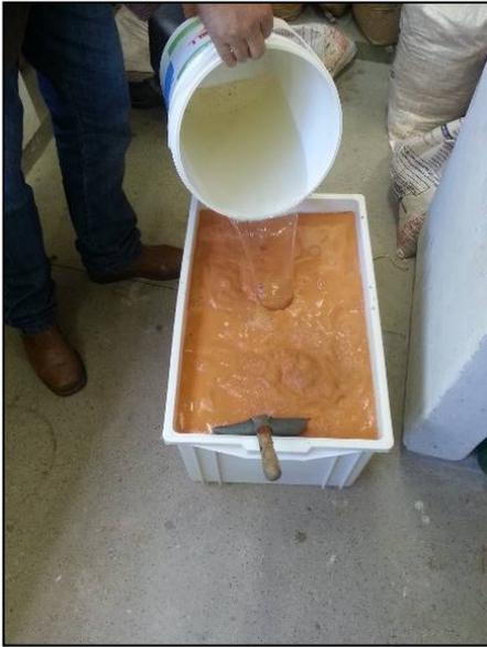
Figura 10. Introdução de H<sub>2</sub>O + NaOH.
