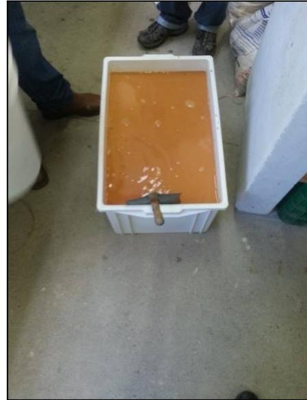
Figura 11. Homogeneizando a amostra de Solo + H<sub>2</sub>O + NaOH.
