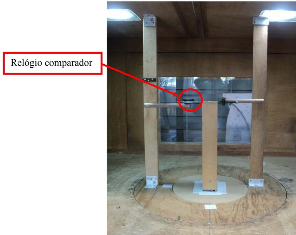
Figura 45: calibração dos sensores ópticos utilizados na BD3GDL
