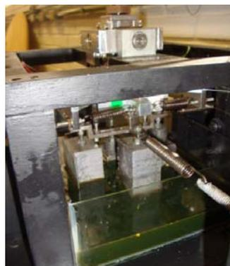
Figura 39: BD3GDL com molhas, massas e amortecedores instalados
