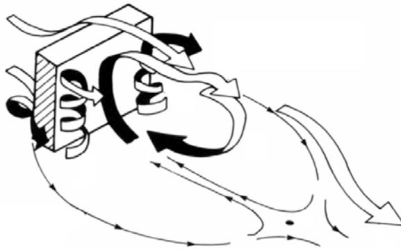
Figura 4: esteira turbulenta (adaptada de COOK, 1985, p. 174)
