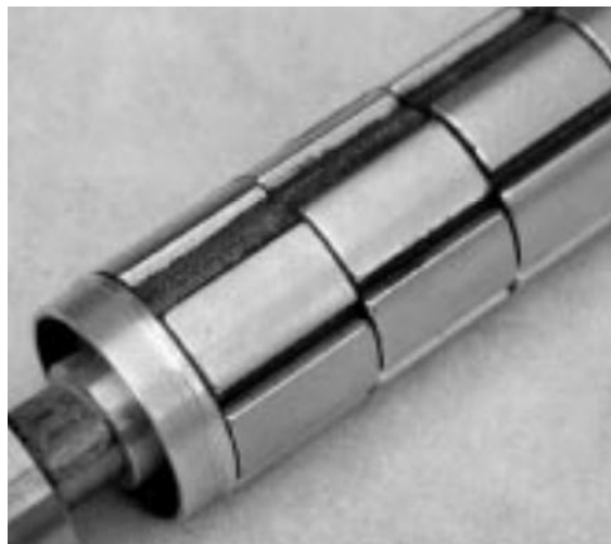
Figura 22 - Foto de um rotor com os ímãs defasados
