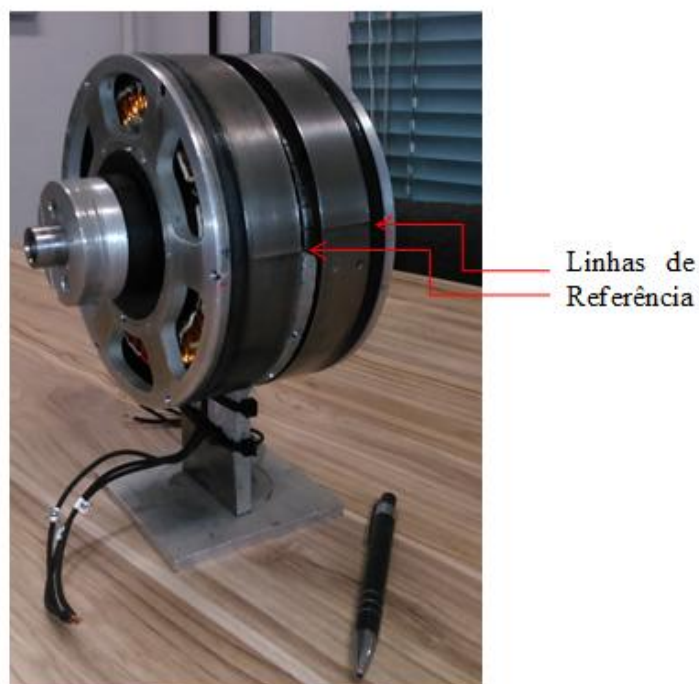
Figura 66 - Detalhe da defasagem entre as duas partes do rotor
