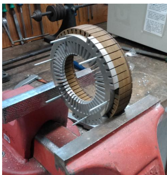
Figura 48 - Montagem do núcleo do estator
