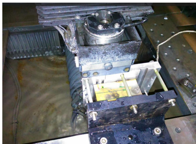
Figura 29 - Corte dos ímãs na máquina de eletroerosão – FANUC
