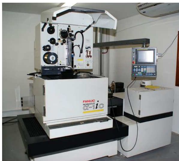
Figura 35 - Máquina de eletroerosão a fio
