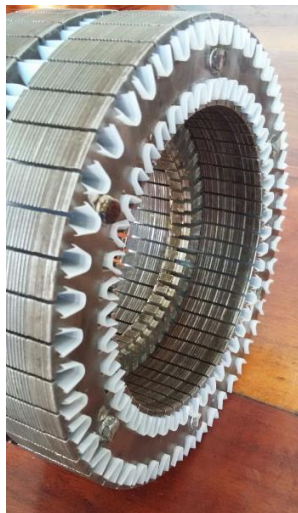
Figura 49 - Isolação das ranhuras do estator
