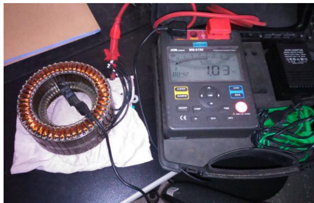
Figura 90 - Medição da isolamento elétrica das bobinas
