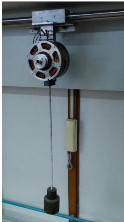
Figura 91 - Montagem para ensaio com acionamento sinusoidal
