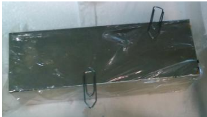
Figura 28 - Bloco de NdFeB magnetizado
