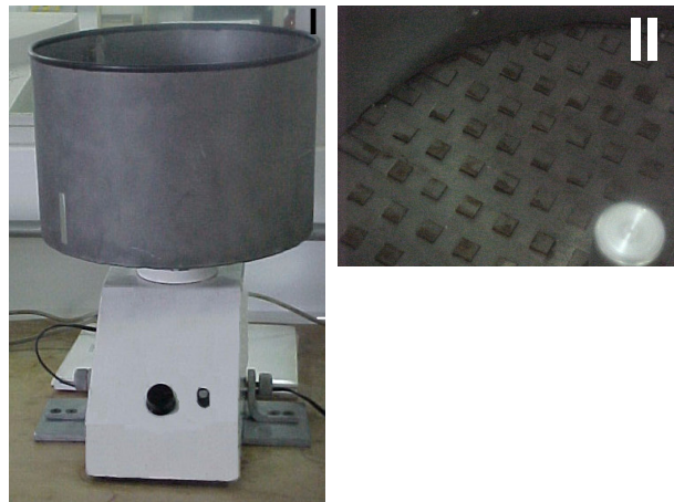
Figura 11. I = esferonizador; II = base do disco do esferonizador
