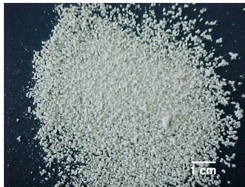
Figura 43. Extrusados de Avicel PH 101 com etanol como líquido de aglutinação.
