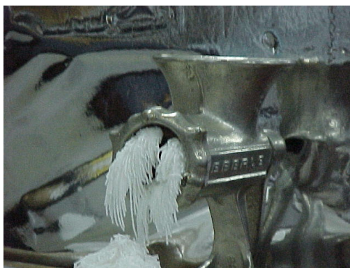
Figura 45. Extrusão da formulação ACN-6.
