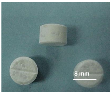
Figura 62. Comprimidos da formulação MPVPX-2 (Microcel MC 101, crospovidona e solução aquosa de PVP 2 % como líquido de aglutinação).
