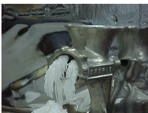
Figura 45. Extrusão da formulação ACN-6.
