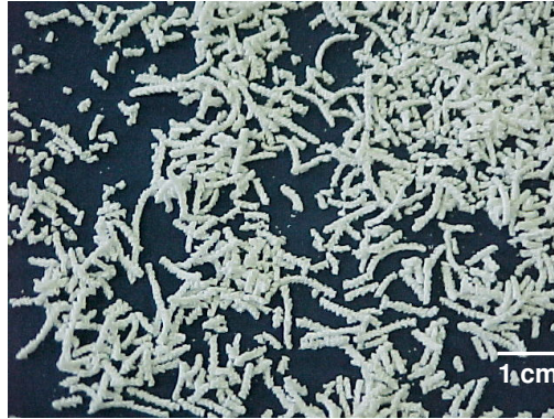
Figura 42. Extrusados de Avicel PH 101 com água como líquido de aglutinação.
