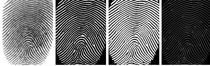
Figura 3.1: (Da esquerda para direita) ID em tons de cinza. ID realçada e binarizada ( a \sim 0,23 ). ID dilatada ( a \sim 0,48 ). ID esqueletizada ( a \sim 0,08 ).
