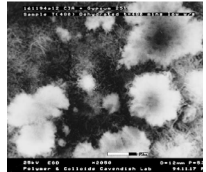
Figura 2.34: placas irregulares de monossulfoaluminato formados a partir de agulhas de etringita. 8 horas de hidratação. a/c=5 . 25% de gipsita. Barra de escala=5 \mu\text{m} .
