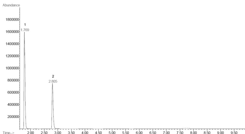
Figura 6. Cromatograma da análise de Etanol (1) e PI (2) em fluido oral utilizando CG/EM.
