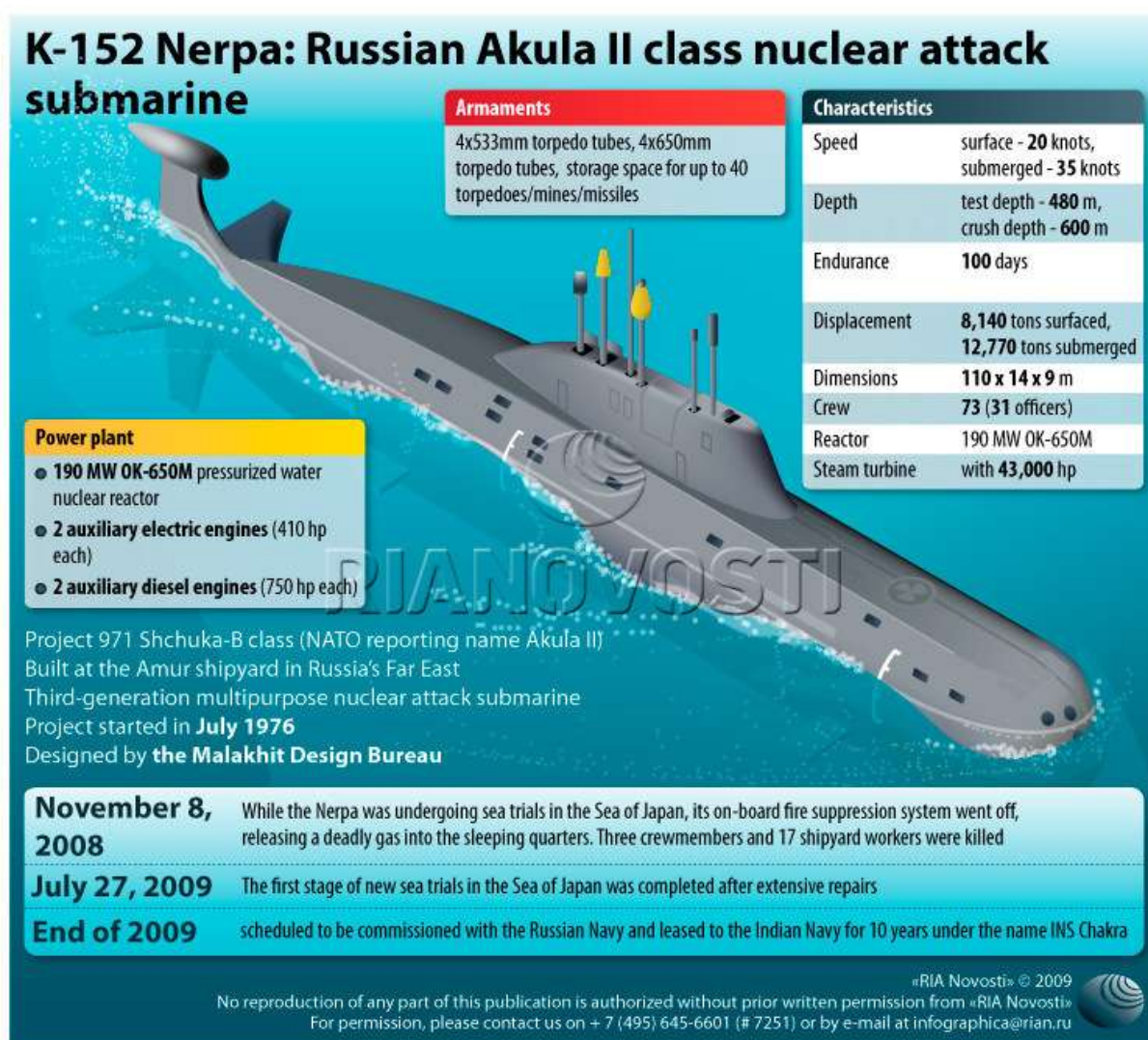
Ilustração 27 – Descrição das Características do Submarino Nerpa (Chakra)
