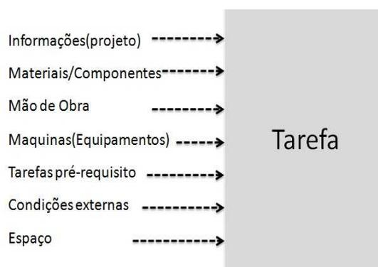
Figura 2-Os pré-requisitos das tarefas da construção (adaptado de Koskela, 2000).
