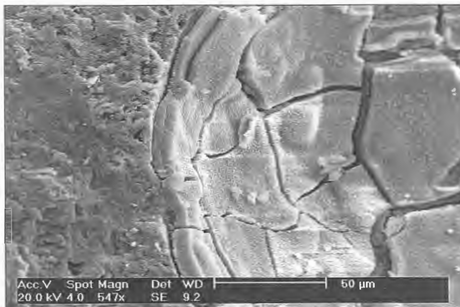
Figura 24: imagem de gel maciço gretado da reação álcali-agregado obtida por Microscopia Eletrônica de Varredura. (VALDUGA, 2002).
