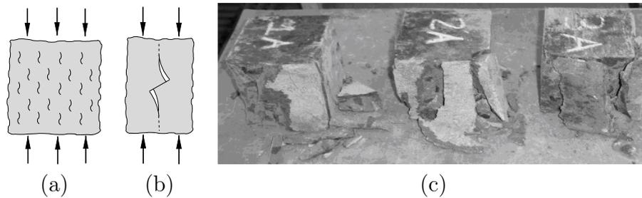
Figura 4.10 – Ilustração do processo de dano em materiais quase-frágeis sob compressão uniaxial: (a) fissuras aparecem na direção de carregamento, (b) auto-organização e propagação em ângulo, onde o processo de dissipação por deslizamento começa a ser dominante. (c) Resultados experimentais para o caso sem restrição lateral em ambas extremidades.
