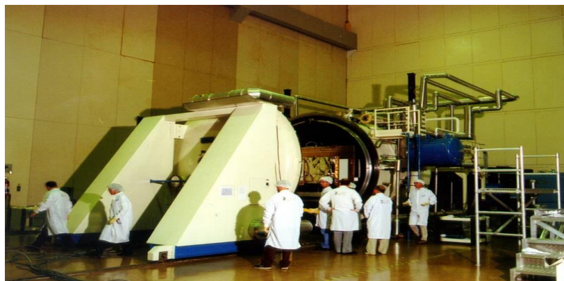
Imagem 6 – Testes de termo-vácuo do módulo de serviço
