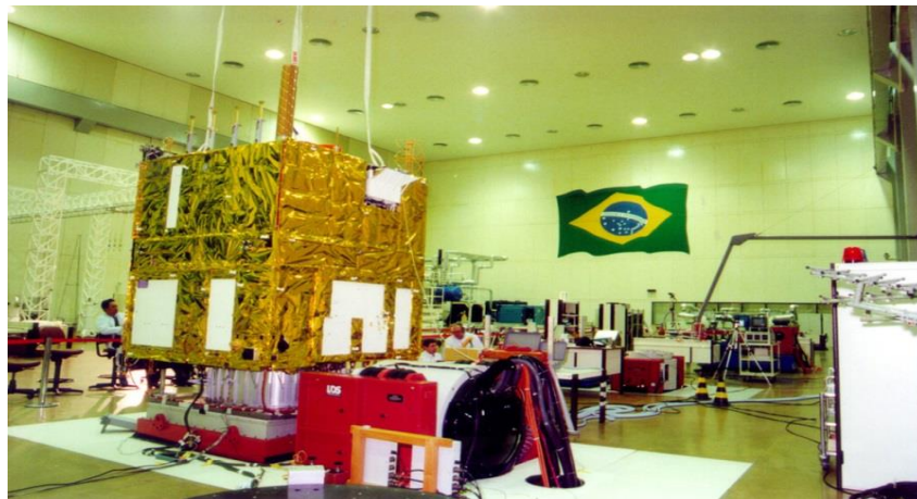
Imagem 5 – Teste de vibração do CBERS-2
