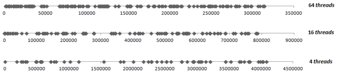
Figura 5.8: Momento da injeção da falha nos registradores de dados que resultou em erro no algoritmo multiplicação de matrizes
