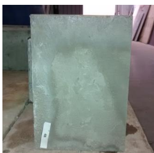
Figura 44: corpo de prova para o ensaio de esclerometria
