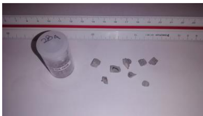
Figura 47: fragmentos de argamassa para análise de porosimetria por intrusão de mercúrio dos concretos
