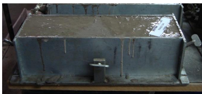
Figura 37: fôrma prismática de 100 x 100 x 350 mm
