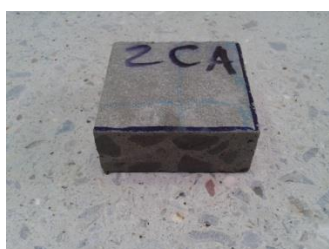
Figura 41: CP para o ensaio de resistência à abrasão - NBR 12042
