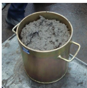
Figura 38: cilindro metálico de 250 mm de diâmetro e 280 mm de altura
