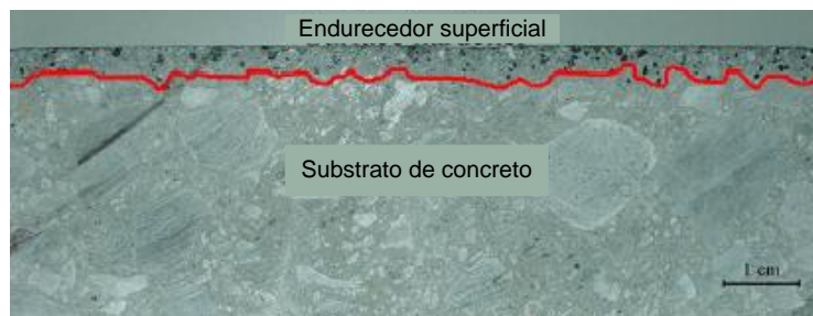
Figura 7: amostra laboratorial mostrando endurecedor superficial incorporado ao substrato de concreto (adaptado de GARCÍA; FRESNO; POLANCO, 2008)
