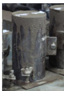
Figura 36: fôrma cilíndrica de 100 x 200 mm
