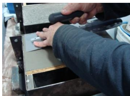
Figura 17: acabamento superficial do concreto
