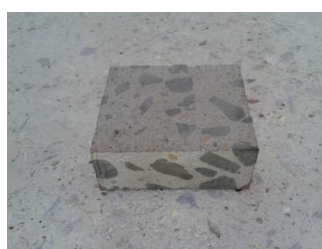
Figura 42: CP após ensaio de resistência à abrasão - NBR 12042
