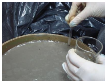
Figura 14: coleta de água exsudada
