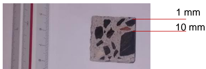
Figura 51: posições de indentação nas amostras de concreto
