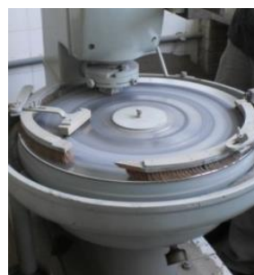
Figura 19: ensaio de resistência à abrasão
