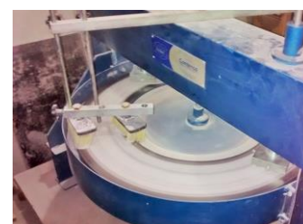
Figura 43: equipamento para ensaio de resistência à abrasão - NBR 12042
