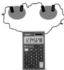
Figura 18. Esquema de montagem da pilha de limão e uso em calculadora.
