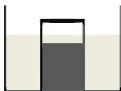
Figura 16. Nível correto da água/gelo em relação ao nível de amostra no béquer, para garantir maior homogeneidade de temperatura na amostra.
