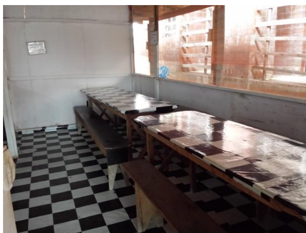
Figura 14 – Refeitório fechado com tela e mesas com tampo lavável na obra 10
