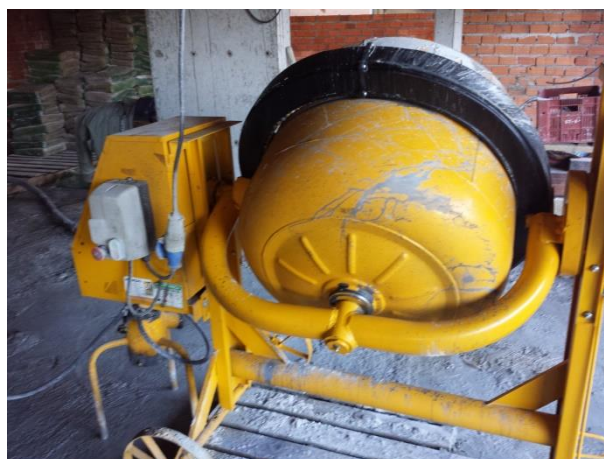
Figura 37 – Exemplo de betoneira aterrada na obra 11
