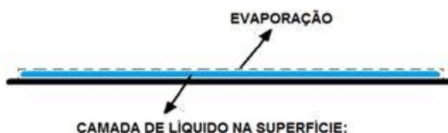
Figura 8 - Representação esquemática de uma dispersão filmógena disposta sobre a placa para eliminação do solvente
