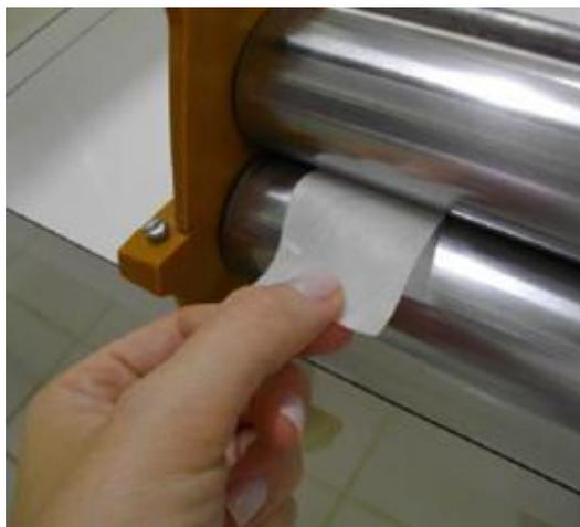
Figura 22- Etapa de laminação da massa polimérica após a etapa de plastificação
