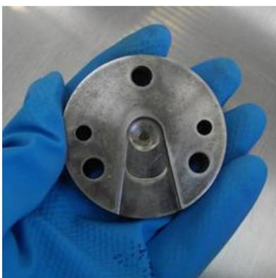
Figura 18 - Matriz do protótipo usinada em aço tratado
