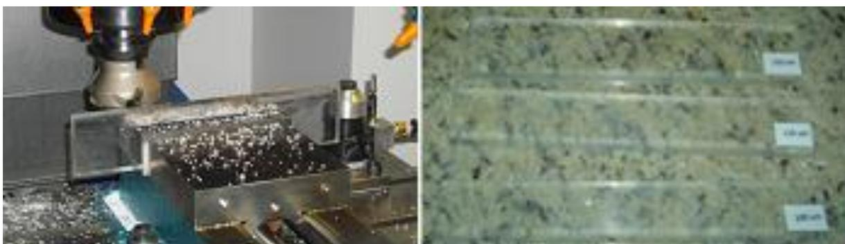
Figura 31 - Usinagem de um laminador em torno CNC(a) e laminadores prontos e identificados em espessura de laminação (b).
