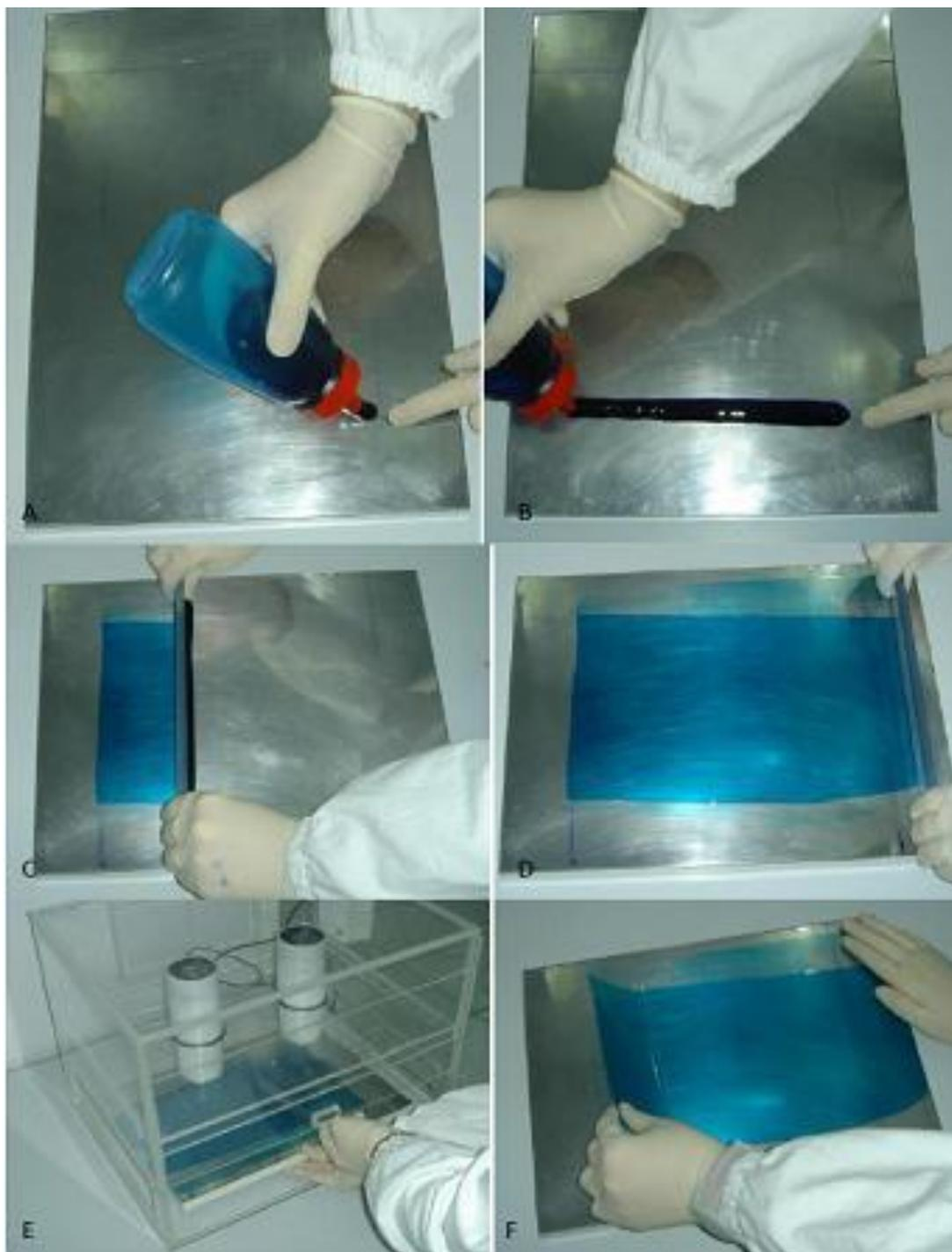
Figura 35 - Esquema detalhado do método de produção de filmes por laminação e evaporação do solvente.
