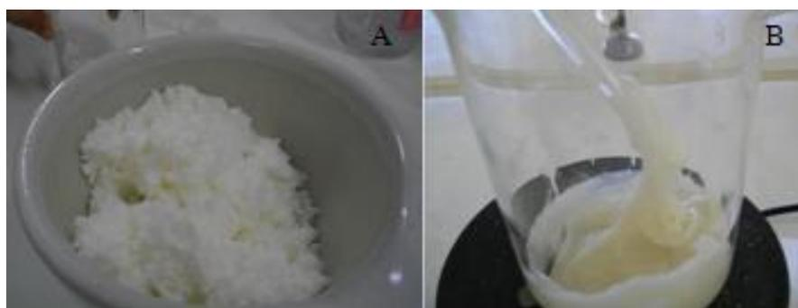
Figura 21 (A) Grânulos de maltodextrina em etapa de plastificação, (B) grânulos de maltodextrina e sorbitol em processo de plastificação.
